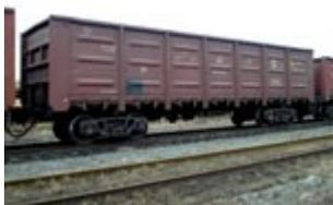
Полувагон - предназначен для перевозки навалочных и штучных грузов, не требующих защиты от атмосферных осадков. Полувагоны не имеют крыши, что позволяет полностью механизировать погрузку. Для механизации разгрузки сыпучих грузов большинство полувагонов имеют люки в полу или в нижней части торцевых стен.
