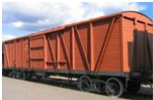
Крытый грузовой вагон - предназначен для перевозки штучных (мешки, коробки, паллеты) и насыпных грузов, требующих защиты от атмосферных осадков. Универсальные крытые вагоны имеют в боковых стенах двери для погрузки-выгрузки, люки для освещения и вентиляции. Погрузка/выгрузка осуществляется как механизированным способом, так и вручную.
