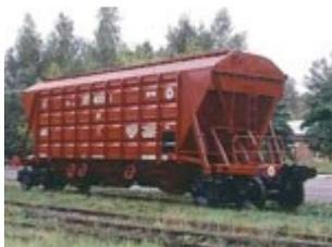
Хоппер (horreg (англ.)-бункер) - разновидность полувагона. Используется для перевозок сыпучих грузов. Для перевозок цемента, зерна и других сыпучих материалов, требующих защиты от атмосферных осадков, применяются крытые хопперы с люками для загрузки на крыше.
