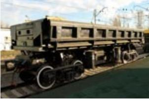
Думпкар (to dump (англ.)-опрокидывать, саг-вагон)с-свагон-самосвал. Он применяется для перевозки и механизированной разгрузки сыпучих и грузов, имеющих крупную гранулированную консистенцию.
