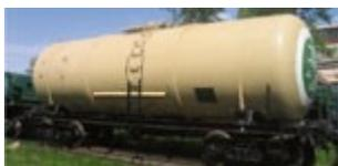
Вагон-цистерна - предназначен для перевозки жидких грузов, нефтепродуктов, сжиженных газов и порошкообразных материалов.
