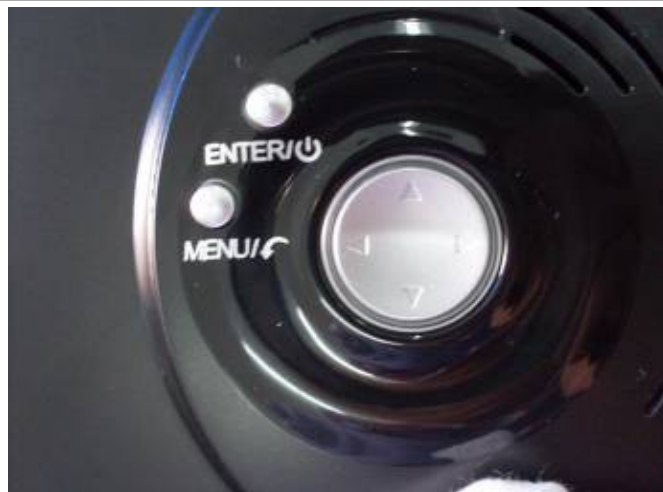
Кнопки управления на задней панели
