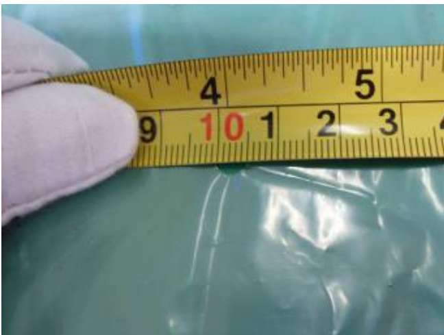
Размер вентиляционных отверстий 5mm
